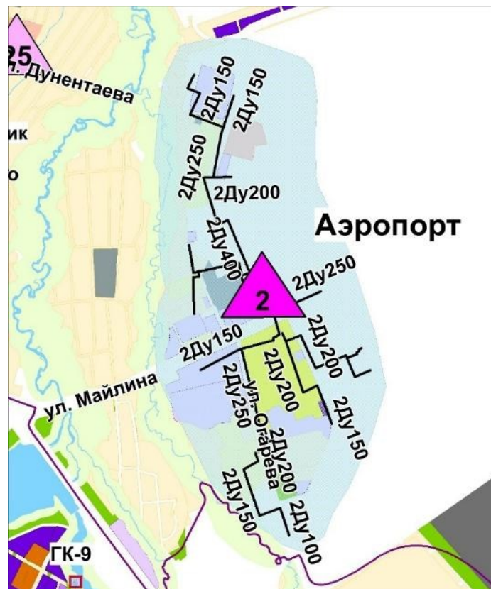
Рисунок 6.3.6.1. Карта-схема развития зоны котельной Аэропорт ТОО "АТКЭ" с нанесением существующих и перспективных магистральных тепловых сетей в период до 2040 г.
